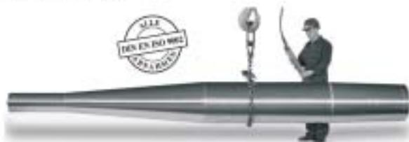
Rohrwaile für Steuerender eines Containerschiffes
